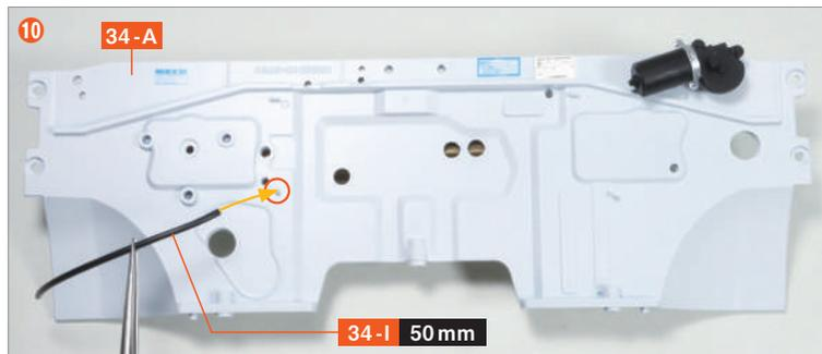
把在 step1 中裁剪好的油門電線 34-I 插入 34-A 的突起部分中。
