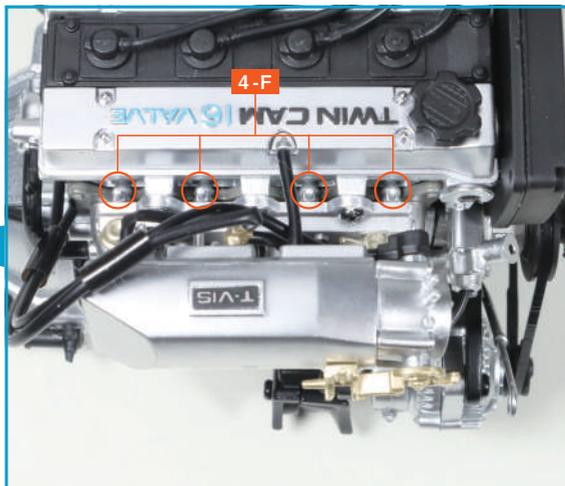
備妥已組裝至第15期的引擎，並確認在 **step 1** 中裁剪出的噴油器電線其安裝位置。將噴油器電線連接到已組裝至第4期的噴油器 **4-F** 的突起部分上。
